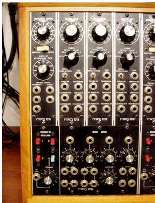
Ob der Klang hörbar ist, hängt oft von der Tonhöhe ab, denn die Oszillatoren können auch außerhalb des menschlichen Hörvermögens Signale erzeugen. Mit dem Drehregler “Frequency” kann die Grundfrequenz des Oszillators verändert werden, der Schalter “Range” gibt dabei die Lage vor. Die Beschriftung orientiert sich an den Registern der Orgel.
