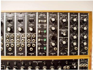
Bei den Verstärkermusername (Amplifier) wird die Amplitude des Eingangssignals verändert, genauso wie bei einem der Mixerkanäle. Der Unterschied zu einem Mixerkanal besteht darin, dass die Lautstärkeregelung nicht ausschließlich über die Drehpotiometer (Drehknöpfe) sondern auch über eingehende Steuersignale (Voltage Control, daher VCA) geregelt werden kann.
