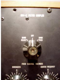
Je nach Einstellung können beide Filter zusammen als “Band Reject” (entfernt die Frequenzen zwischen den Filtergrenzen) oder “Band Pass” Filter fungieren. Dazu kann das Ausgangssignal direkt mit dem 904C verbunden werden.
