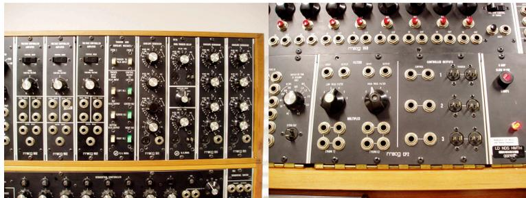
Da die Envelope Generatoren die üblichen Steuerspannungen ausgeben, lassen sich diese wieder auf alle anderen Control-Inputs anwenden.
