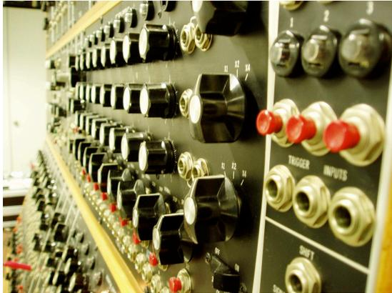
Der untere Teil: Sequential Controller, Multiples, 7 Oszillatoren, 3 Mixer, Controller-Outs der externen Geräte
